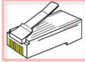
( 3 ) يتم وصل الكابل بالـ RJ-45 عن طريق . (UTP crimping tool)
